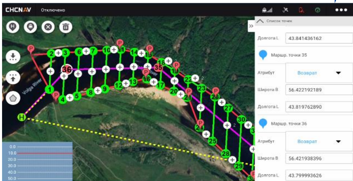
Рис. 7.7 Создание линии возврата
