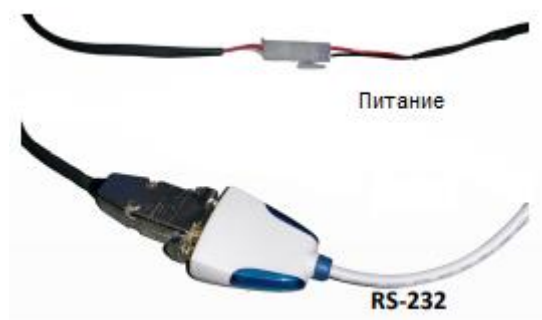
Рис.1.3. Подключение кабелей питания и передачи данных
