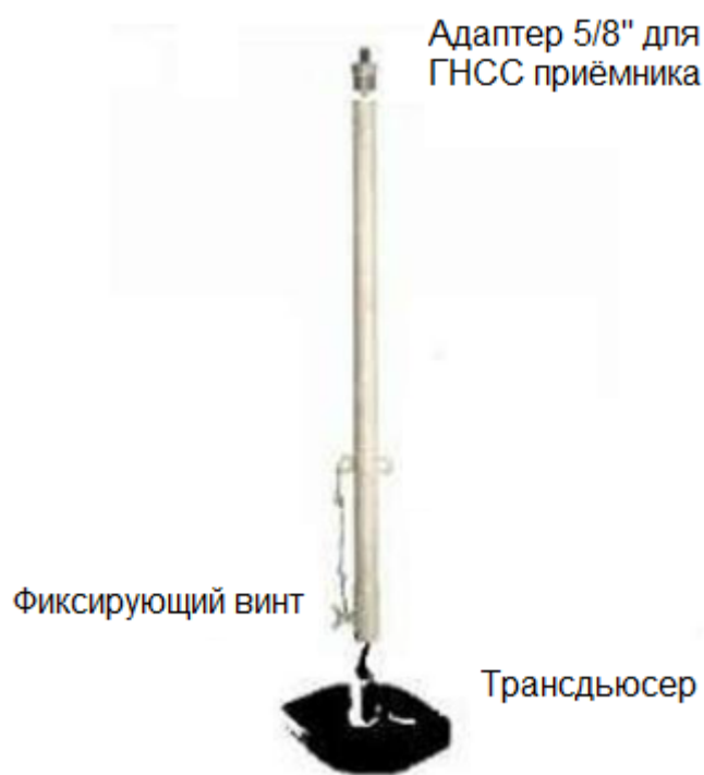
Рис. 2.1 Монтаж оборудования на вехе
