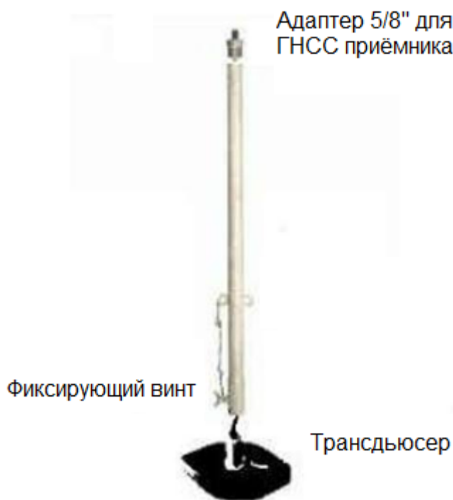
Рис. 2.4 Монтаж оборудования на вехе
