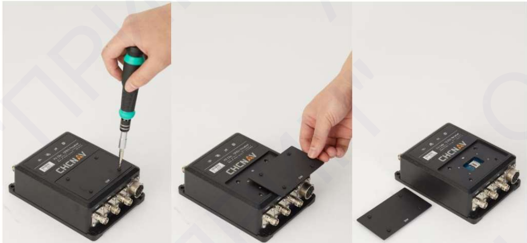
Рис.1.5. Снятие крышки отсека для SIM-карты
