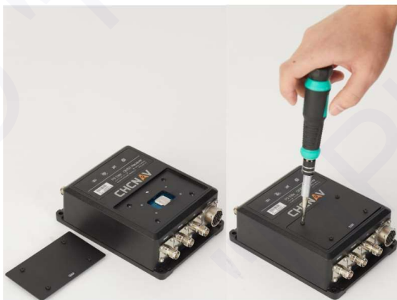
Рис.1.7. Закрепление крышки отсека для SIM-карты
